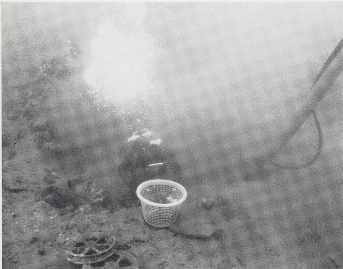
Afb. 3. Het bergen van kleinere voorwerpen met behulp van een 'airlift'. Op de voorgrond twee van de bronzen schijven (Foto Robert Sténuit).
