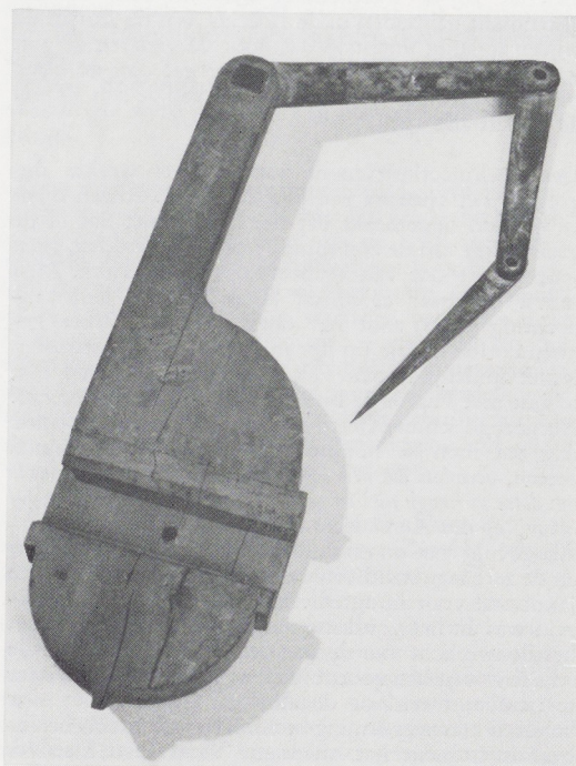
Afb. 5. Zgn. 'armken van Barents'. Onderdeel van een astrolabium catholicum ter oplossing van bol-driehoeken. Rijksmuseum, Amsterdam.
